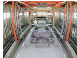
Revestimento por Imersão
