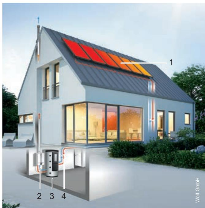
Instalaciones termosolares para el calentamiento de agua potable en viviendas unifamiliares: **1)** colector **2)** caldera **3)** acumulador **4)** central solar con regulador solar integrado.
