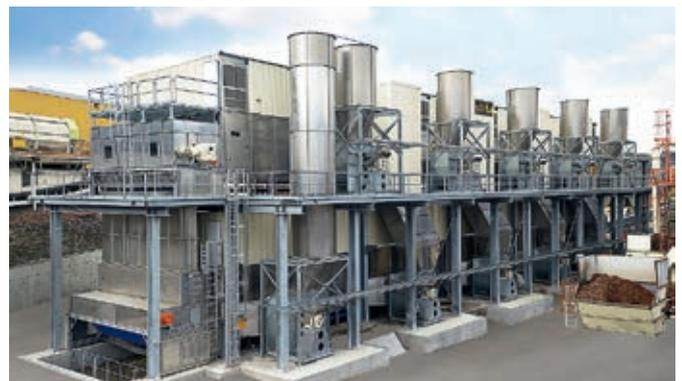
Secador de bandas a baja temperatura BTU 2/6200-45 - 10/4.
