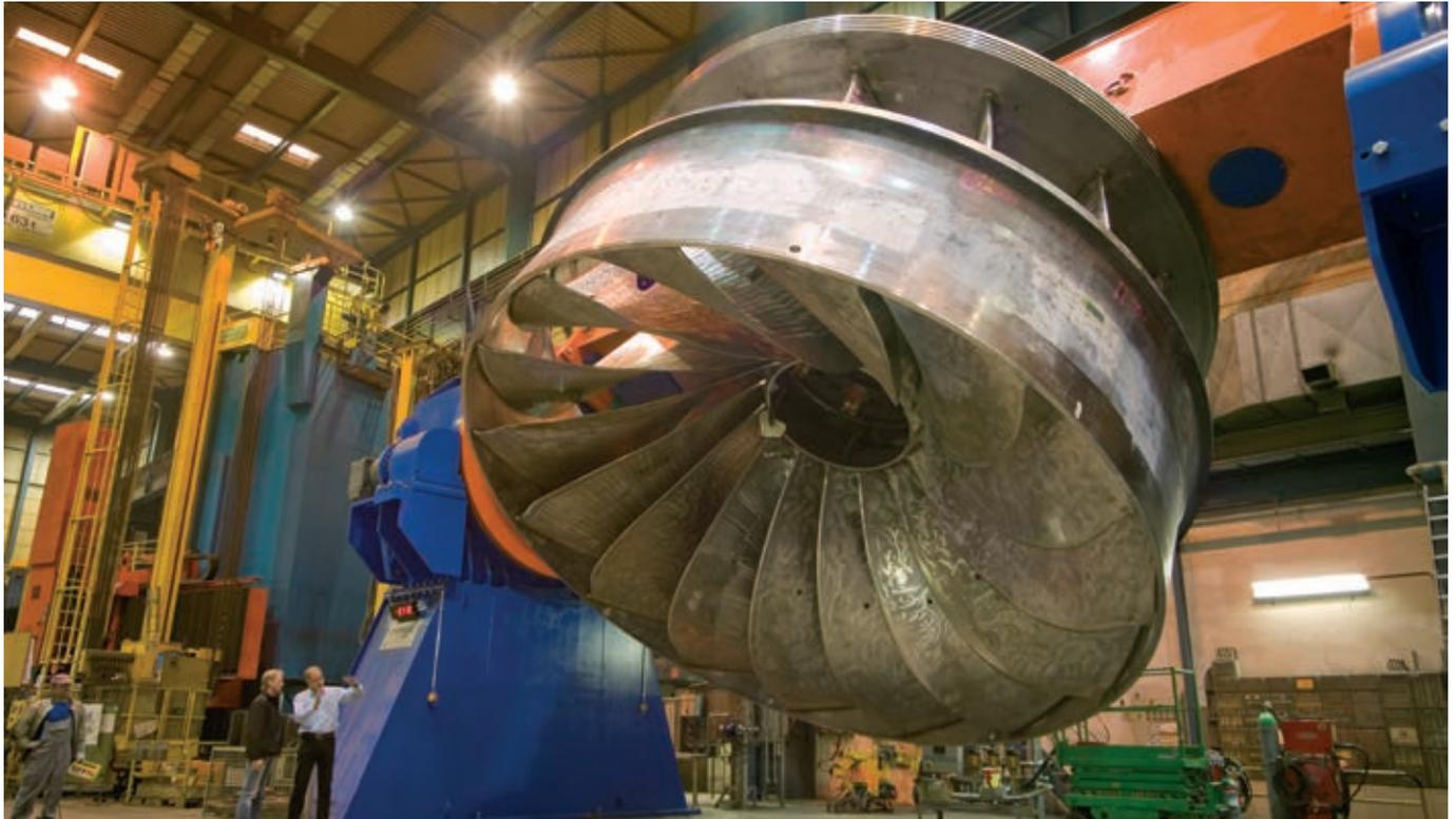
Fabricación de un rotor Francis en la planta de Ravensburg.
