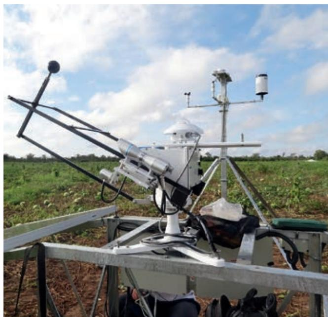
Estaciones de medición para la valoración de la energía eólica y solar.
