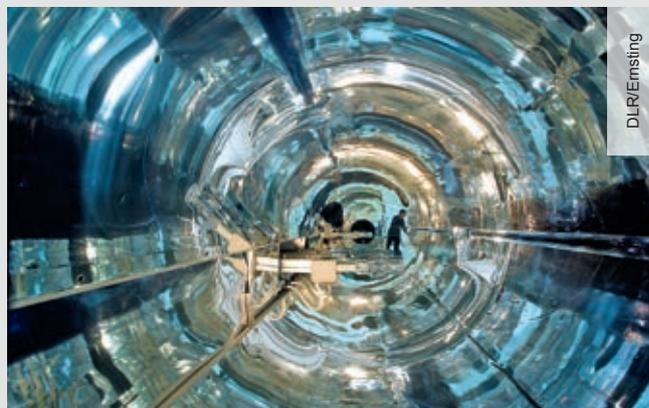
En el centro QUARZ del Instituto DLR para la investigación solar en Colonia, se prueba la capacidad de rendimiento de los receptores y los espejos de las centrales solares. La instalación de pruebas ElliRec, accionada con lámparas, del centro de pruebas y cualificación (QUARZ) simula la luz solar y comprueba la capacidad de conversión que presentan los tubos absorbentes a la hora de transformar esta luz en calor.
