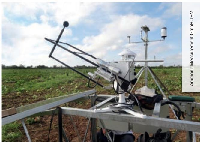
Estación de medición solar para la medición de radiación global, difusa y directa, así como de valores meteorológicos.
