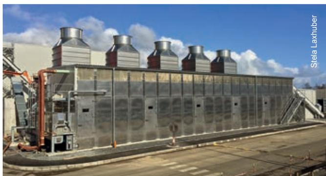
Secadero de banda a baja temperatura de Stela para el secado de virutas de madera.
